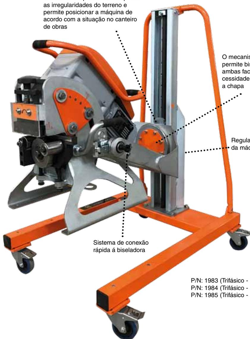
O mecanismo rotativo permite biselar em ambas faces sem a necessidade de manipular a chapa
