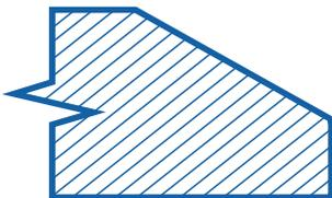
Ancho de bisel 18 mm / 0.7 in en el primer corte con velocidad de avance de 1,8 m/min. / 5.9 pies/min
